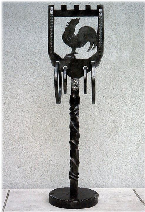
una macchina a controllo numerico. Dopo che la macchina ha fatto le varie lavorazioni abbiamo preso la base della caveia e l'abbiamo messa nella fresa a controllo manuale dove la prima lavorazione è quella di fare lo squadro 50x50 con una fresa di diametro 40 in metallo duro. Abbiamo sfiorato sul lato di misura 25, poi sul diametro 71 e abbiamo fatto quattro lavorazioni da 2,5 millimetri, per poi ripeterlo anche negli altri 3 lati. Dopo questa fase si esegue un altro squadro 60x60.
